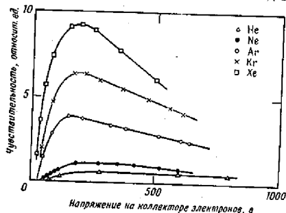
Фиг. 26. Зависимость чувствительности по инертным газам манометра Байярда — Альперта от напряжения на коллекторе электронов (Кобик и др. [18]).
