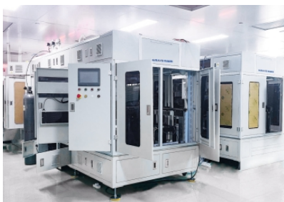
01. Автоматизированная гелиевая установка контроля соединителей UQD
