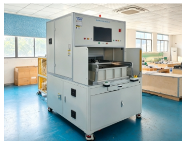
02. Гелиевая установка контроля охлаждающих плит
