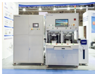
04. Гелиевая установка контроля микроканальных охлаждающих плит
