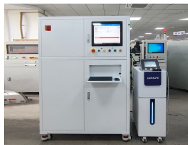
08. Контроль блоков CDU методом щупа или в вакуумной камере
