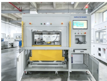
07. Гелиевая установка контроля серверов с жидкостным охлаждением
