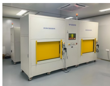
06. Гелиевая установка контроля сильфонов
