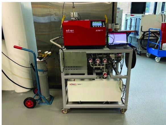
Установка исследования газопроницаемости / Измерительная ячейка
