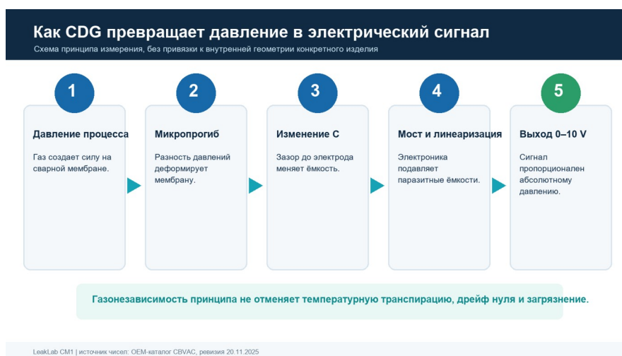
Принцип действия CDG
