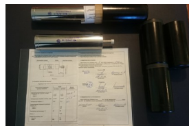
Комплект для калибровки гелиевого течеискателя с клапаном ЛИКЛАБ К-КФ25 / Меры потока Гелит и комплект метрологических документов
