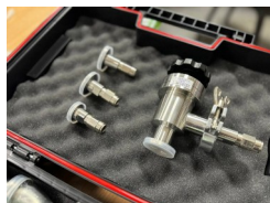
Комплект для калибровки гелиевого течеискателя с клапаном ЛИКЛАБ К-КФ25 / Меры потока Гелит и комплект метрологических документов
