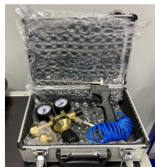
Щуп LeakLab для масс-спектрометрического течеискателя / Обдуватель для течеискателя Ликлаб-ОГ
