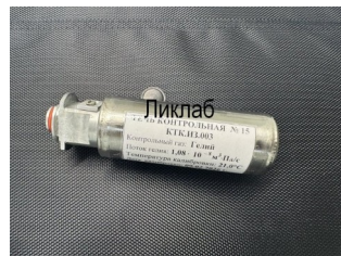
Внутренняя калиброванная течь ASM 340 121528S / Калиброванная внутренняя течь Ликлаб КТК.ИЗ.003
